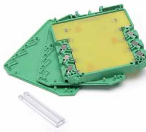
Prodotto smontato: per asportare il circuito stampato è necessario dissaldare i morsetti. Disassembled product: unweld the terminals pins first and remove the printed circuit board after.
