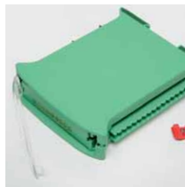
Inserimento del coperchio nella base del contenitore. Insertion of the cover into the base of the enclosure.
