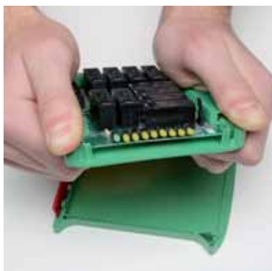
Estrazione della scheda elettronica. Removing the pcb.
