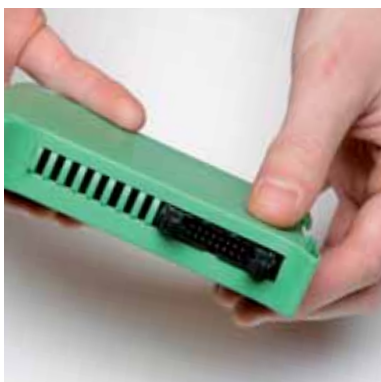
Chiusura del contenitore. Closing the enclosure.
