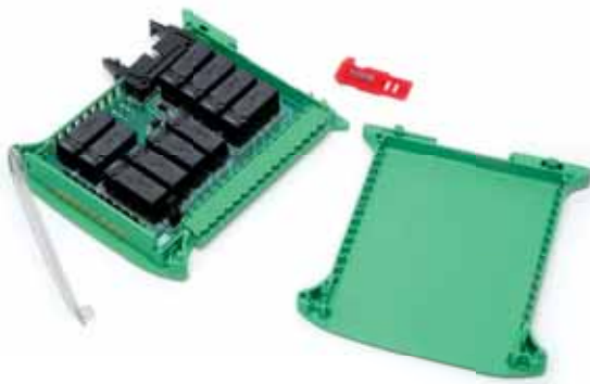
Inserimento della scheda elettronica nella base del contenitore. Insertion of the PCB into the base of the enclosure.
