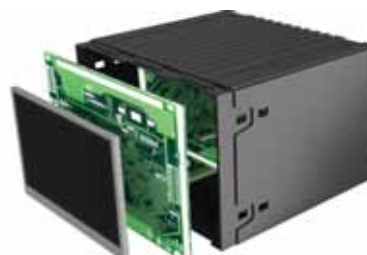
PCB 144.96 con display / PCB 144.96 with display
