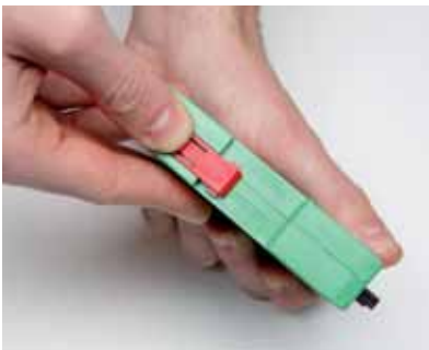
Smontaggio del gancio. Nota: premere sulla base del contenitore e far scivolare il gancio fuori sede. Disassembling the hook. Note: press on the base of the enclosure and make the hook slide out of its position.
