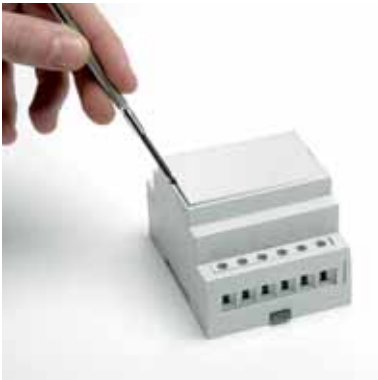
Rimuovere il pannello Remove the panel
