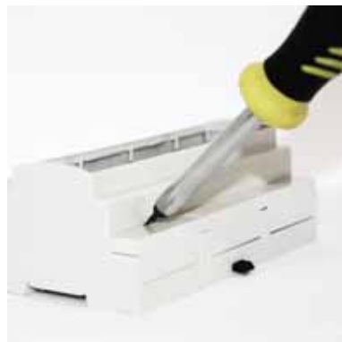
Rimuovere i coprimorsetti Remove the terminal covers
